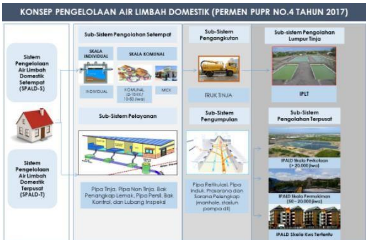
Gambar 2.1.5.1.2. Diagram Pengelolaan SPALD-T
